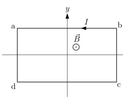
۷) در شکل مقابل، میدان مغناطیسی یکنواخت  $\vec{B}$  عمود بر صفحه شکل (در راستای محور  $z$ ) و به سمت بیرون برقرار است. در سیم مستطیل شکل abcd به طور ناگهانی جریان  $I$  را برقرار می‌کنیم. کدام گزینه بعد از برقراری جریان صحیح است؟
