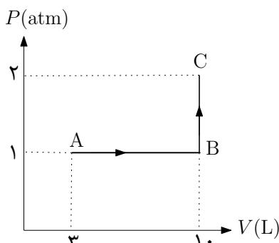
۹) معادلهٔ حالت گاز آرمانی با فرض نقطه‌ای بودن ذرات گاز به دست می‌آید. اگر به جای آن فرض کنیم ذرات گاز کره‌های کوچکی هستند، معادلهٔ حالت گاز به صورت  $P(V - nb) = nRT$  ثابتی است که به نوع گاز بستگی دارد.
