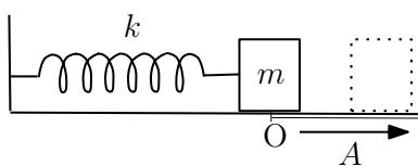
مطابق شکل، جرم  $m$  را از نقطهٔ تعادل به اندازهٔ طول  $A$  می‌کشیم و آن را بر روی میز افقی بدون اصطکاکی رها می‌کنیم.
