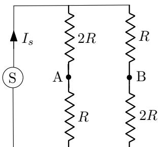
۱۸) در مدار شکل مقابل، منبع جریان ثابت  $I_s$  جریان  $I$  را نشان می‌دهد. این جریان مستقل از آن که چه وسیله‌ای بین نقاط A و B وصل شود همواره ثابت است. اگر بین این دو نقطه ولت‌متر نصب کنیم ولتاژ  $V$  و اگر آمپرمتر وصل کنیم جریان  $I$  را نشان می‌دهد. نسبت  $I/V$  کدام گزینه است؟
