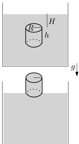
۱۶) یک سطل استوانه‌ای به شعاع قاعده  $R$  و ارتفاع  $h$  دارای جرم و ضخامت ناچیز است. این سطل در ابتدا داخل یک استخر آب به حالت عمودی قرار دارد به طوری که فاصله لبه بالای آن از سطح آزاد آب استخر  $H$  است. شتاب گرانش  $g$  و چگالی آب  $\rho$  است. سطل را به آرامی و بدون ایجاد تلاطم به سمت بالا می‌کشیم تا جایی که سطل پر از آب، از استخر خارج شود و کف آن بر سطح آب مماس شود. در این فرایند چقدر باید روی سطل آب کار انجام دهیم؟
