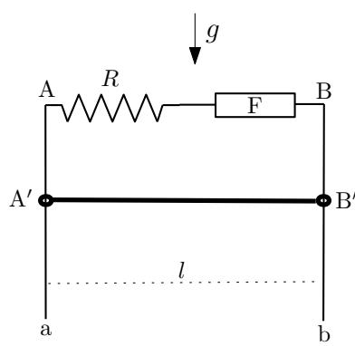
میدان مغناطیسی افقی و یکنواخت  $T = 1/\text{rad}$  عمود بر سطح این مجموعه برقرار است. فیوز  $F$  حداقل می‌تواند اجازه عبور جریان  $A'A' = 50 \text{ A}$  بدهد. حداقل جرم میله  $A'B'$  چند گرم باشد تا فیوز جریان مدار را قطع نکند؟
