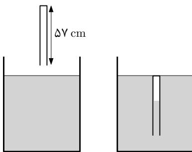
۴) لوله‌ای به ارتفاع ۵۷ سانتی‌متر که انتهای آن بسته است را وارونه کرده و از هوا به طور کامل داخل مایع جیوه می‌کنیم، به طوری که لوله در حالت قائم قرار گیرد و انتهای بسته لوله هم‌تراز سطح آزاد مایع جیوه باشد. به این ترتیب مقداری جیوه داخل لوله می‌شود و حجم هوای محبوس شده را کاهش می‌دهد. از خاصیت مویننگی چشم‌پوشی کنید.
