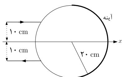
پرتو تابش و بازتاب در صفحه‌ای عمود بر محور استوانه واقع‌اند. بر روی شکل پرتوهای یاد شده فقط در بیرون استوانه رسم شده‌اند. ضریب شکست ماده‌ای که استوانه از آن ساخته شده کدام گزینه است؟
