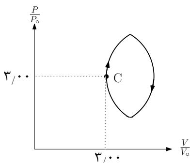
۸) در شکل مقابل یک چرخهٔ ترمودینامیکی در نمودار  $P - V$  نشان داده شده است. فشارها بر حسب فشار معین  $P_0$  و حجم‌ها بر حسب حجم معین  $V_0$  اندازه‌گیری شده‌اند. به این ترتیب کمیت بدون یکای  $P_0/V_0$  بر حسب کمیت بدون یکای  $P/V$  رسم شده است.
